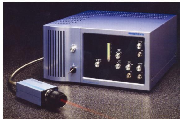
日本公司原装生产的该仪器重11kg，不需要在被测物体上安装传感器，只需对针测量点，对发射激光及接受激光进行特殊技术处理，测量被测物体的振动数据，特别适用于机器零部件，电子元器件等微小物品振动测量。
